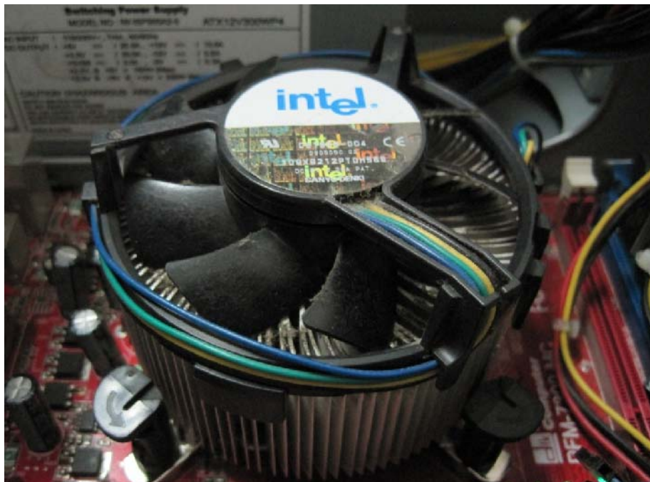
Slika 3.12. Jedna od mogućih izvedbi hladnjaka procesora. Prilikom postavljanja hladnjaka obratiti pažnju na pozicije vijaka koji pričvršćuju hladnjak na matičnu ploču
