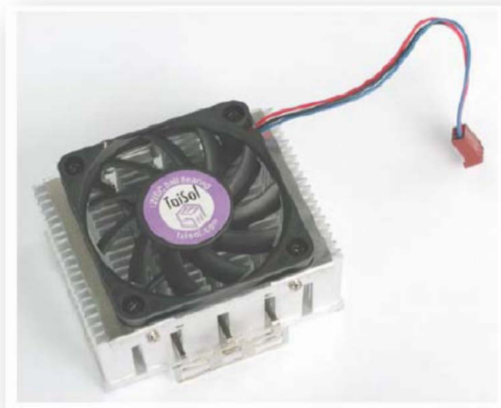
Slika 3.6. Hladnjak sa ventilatorom (aktivni) [9]
