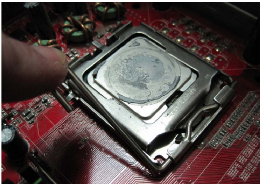
Slika 3.11. Nakon što je procesor postavljen u ležište, potrebno je spustiti sigurnosnu ručicu, koja sprečava ispadanje iz ležišta
